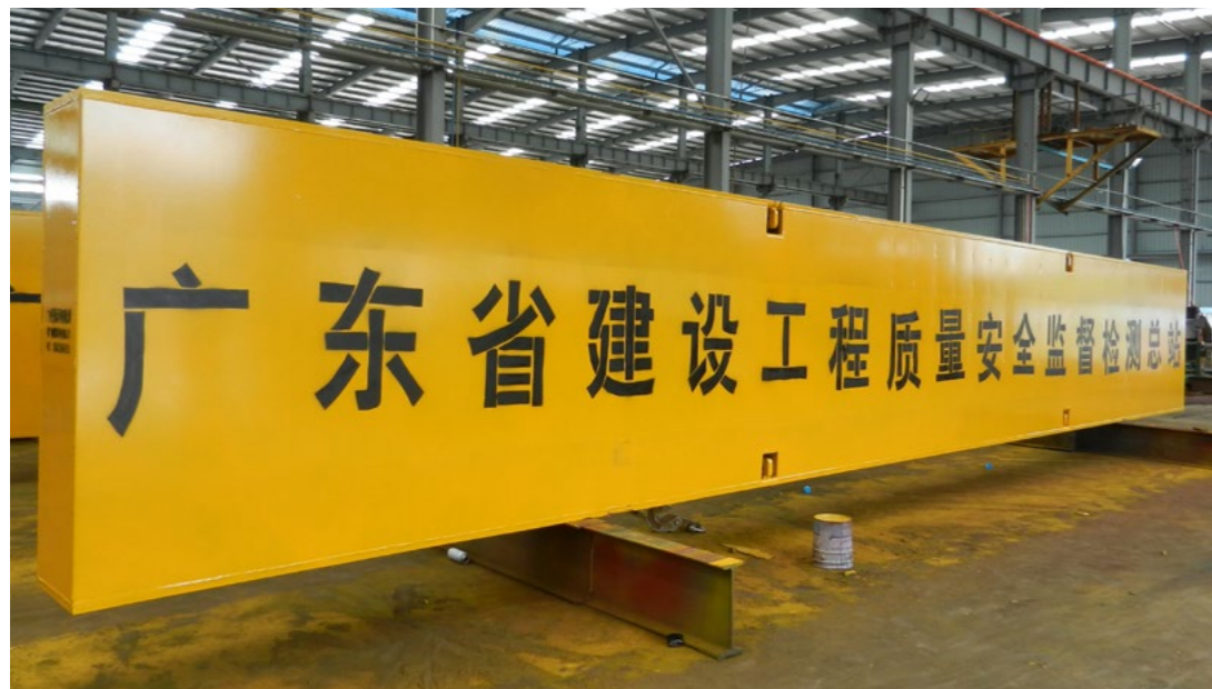
广东省工程质量安全检测中心单根 1000T 组合静载梁
